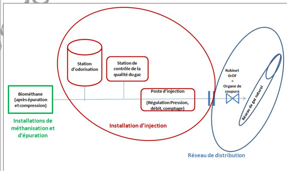
*Positionnement de l'installation d'injection de biogaz dans le réseau public*
